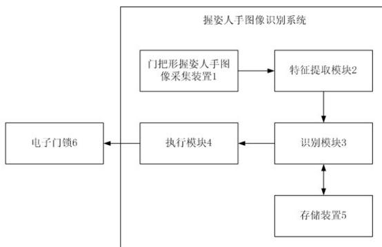
1. 一种门把形握姿人手图像采集装置,用于采集握姿人手图像,其特征在于,包括:侧壁开设有图像采集窗的门把形壳体,及设置于所述门把形壳体内的光源和摄像设备;所述光源发出的光线能够被手掌反射进入所述摄像设备中成像。
